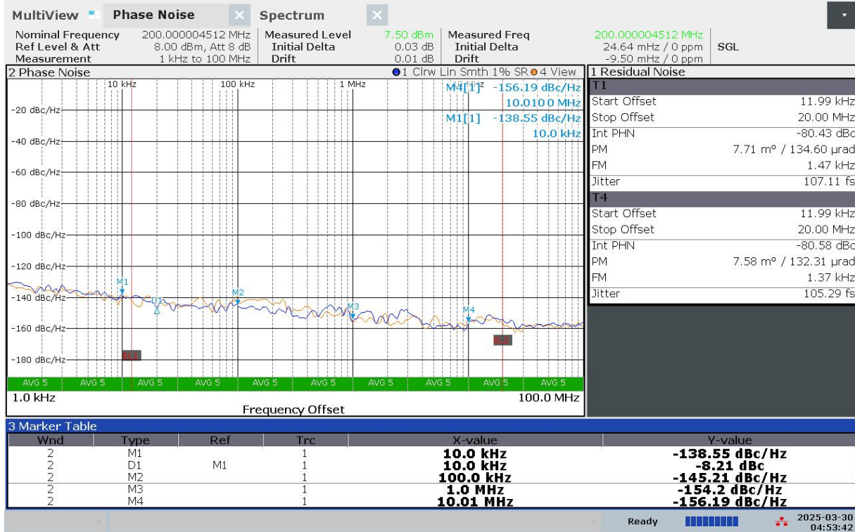
图 CMOS输出200MHz输入信号与输出信号相位噪声曲线
