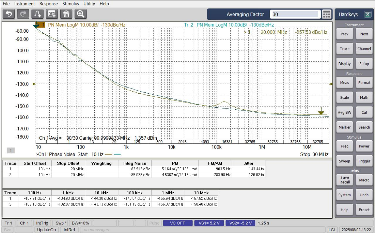
图 100MHz输出信号相位噪声曲线 (VCC=2.5 V)
