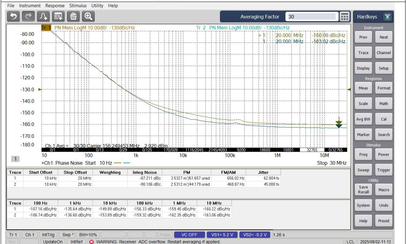
图 156.25MHz输出信号相位噪声曲线 (VCC=3.3 V)
