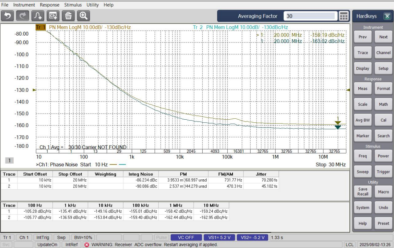
图 156.25MHz输出信号相位噪声曲线 (VCC=2.5 V)
