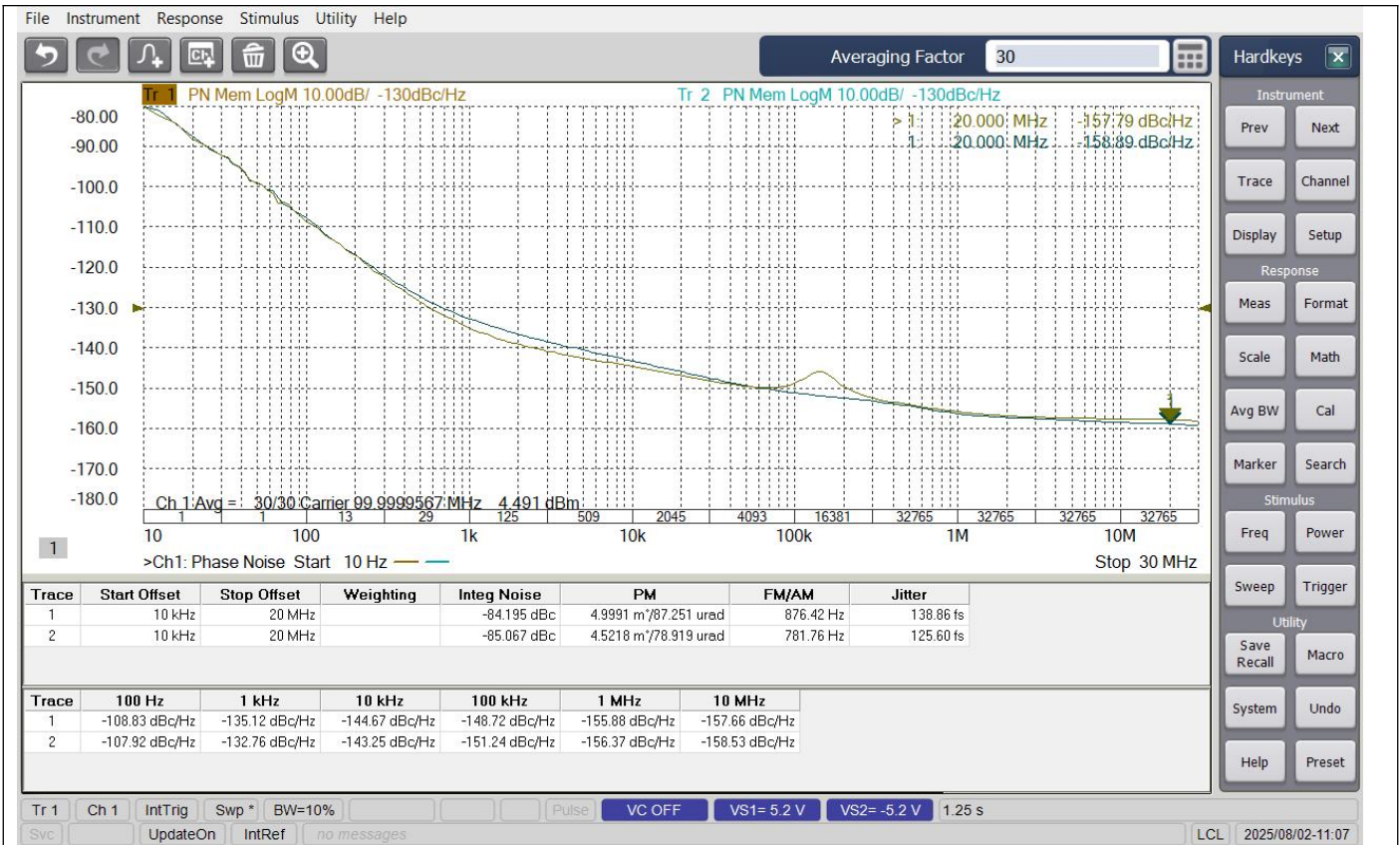
图 100MHz输出信号相位噪声曲线 (VCC=3.3 V)
